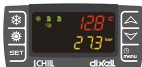
Controllo a microprocessore IC208CX.
